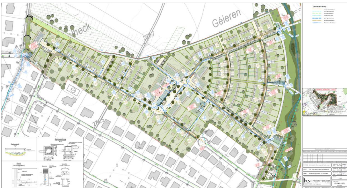
Abbildung 72: Entwässerungskonzept für den PAP „Cité Jardin“ westlicher Teilbereich des Quartiers Op de Wolléken. Quelle: Best, 2020
