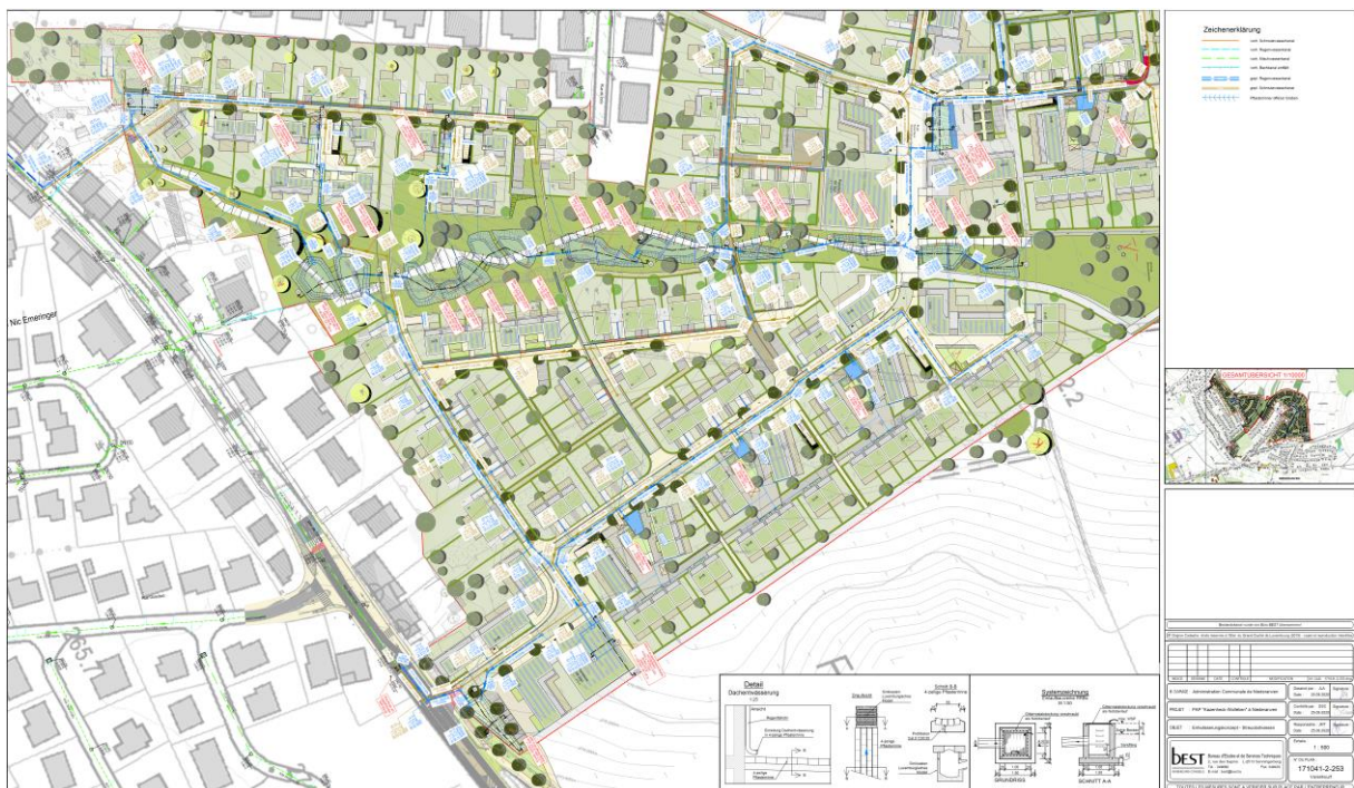
Abbildung 70: Entwässerungskonzept für den PAP „Cité Jardin“ östlicher Teilbereich des Quartiers Streuobstwiese. Quelle: Best, 2020
