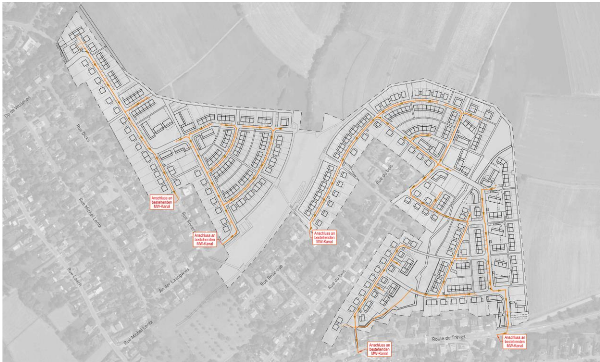
Abbildung 69: Schmutzwasserableitung für den PAP „Cité Jardin“. Quelle: AC Niederanven, 2020
