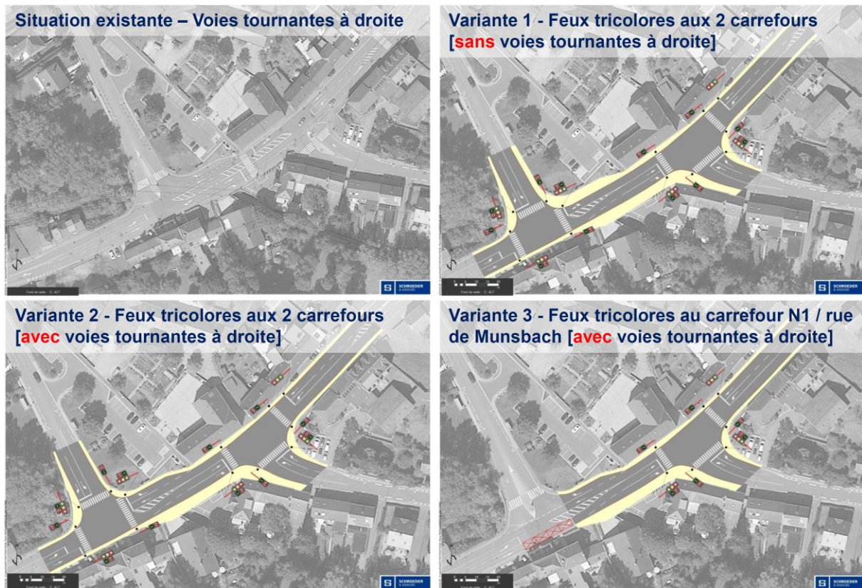
Abbildung 61: Kreuzungsbereich N1/ CR132 mit bestehender Situation und drei Varianten für die Errichtung einer Ampelanlage. Quelle: Schroeder&Associés, 2019
