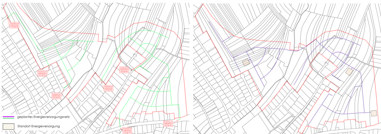
Abbildung 75: Telekommunikationsleitungen (links) und Energieversorgung (rechts) für den PAP „Cité Jardin“ mit Leitungsverlauf unter den Erschließungsstraßen. Quelle: Best, 2024
