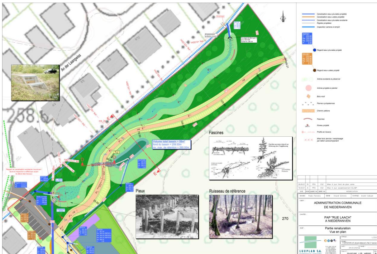
Abbildung 66: Renaturierungsplan für den Brokelsgriecht im Rahmen der Umsetzung des PAP Rue Laach. Quelle: Luxplan, 2021
