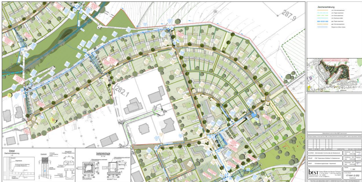
Abbildung 71: Entwässerungskonzept für den PAP „Cité Jardin“ zentraler Teilbereich des Quartiers Kazenheck. Quelle: Best, 2020
